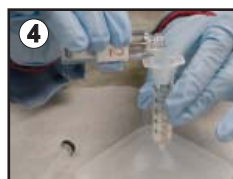
Pour Step 2 Extractor into syringe.
